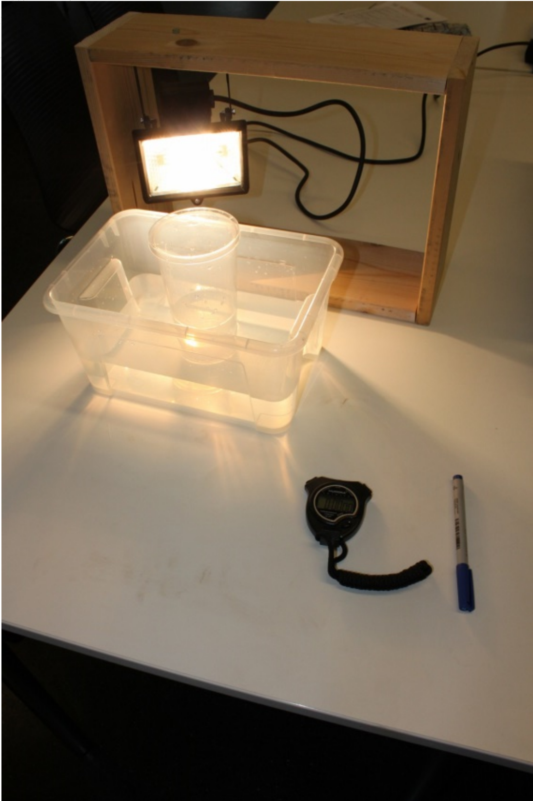
Figura 6: Montaje experimental. Se usa un vaso de plastico como plataforma para el hielo (imagen propia)
